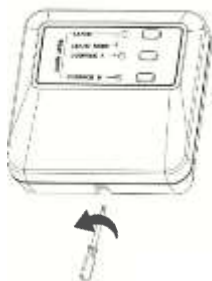
Desurubati surubul de prindere capac (nu complet)
