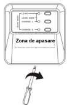
Apasati in zona indicata si insurubati surubul capacului
